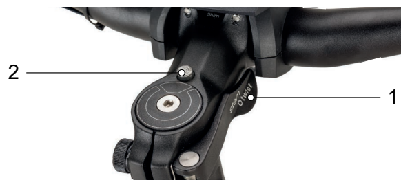
Abbildung 43: Vorbau, Ausführung II mit Spannhebel des Vorbau-Schnellspanners (1) und Entsperrknopf (2)
