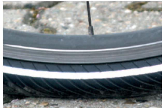
Abbildung 64: Korrekter Fülldruck. Der Reifen ist unter der Last des Körpergewichts kaum verformt
