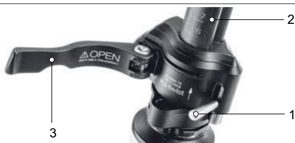
Abbildung 42: Geöffneter Spannhebel des Vorbau-Schnellspanners (3) am Vorbau (2), Ausführung I, mit Sicherungshebel am Vorbau (1)
