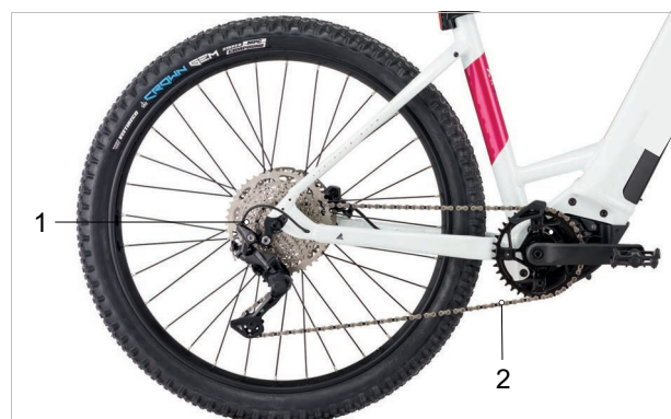
Abbildung 28: Schema Kettenantrieb mit Kettenschaltung
