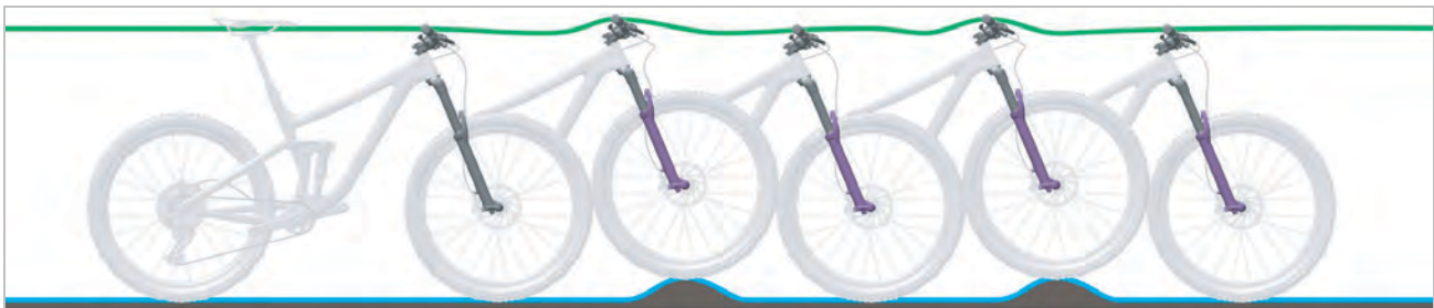
Abbildung 19: Optimales Fahrverhalten der Federgabel
