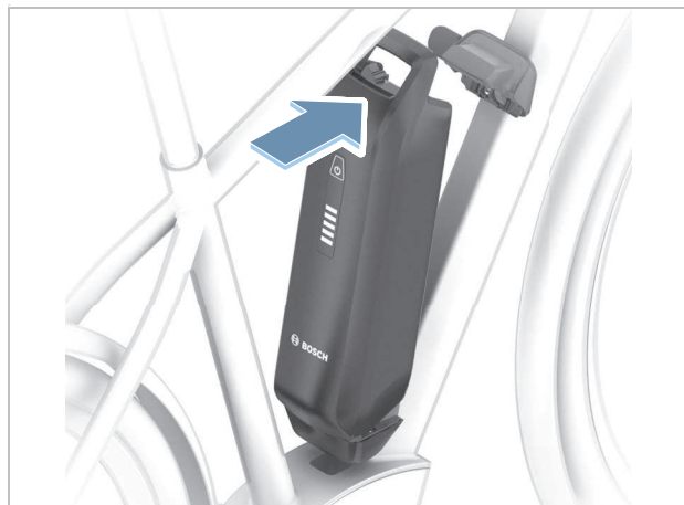
Abbildung 177: PowerPack Akku nach oben klappen
