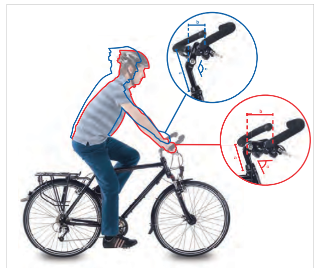
Abbildung 129: Citybike (blau) und Trekkingrad Position (rot) durch Winkeländerung
