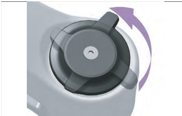
Abbildung 247: Druckstufen-Einsteller weicher einstellen
