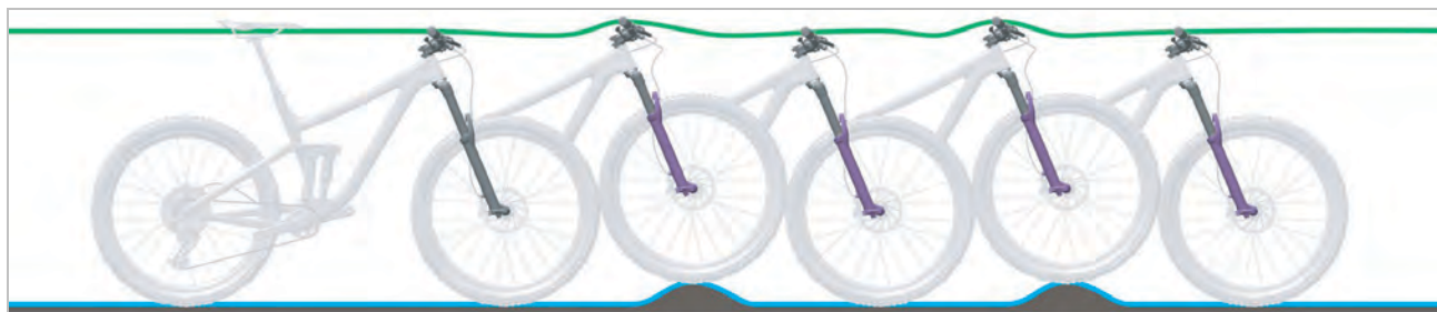
Abbildung 16: Optimales Fahrverhalten der Federgabel
