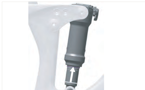
Abbildung 153: O-Ring am Hinterbau-Dämpfer verschieben
