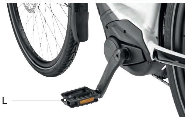
Abbildung 98: L Pedal im linken Kurbelarm
