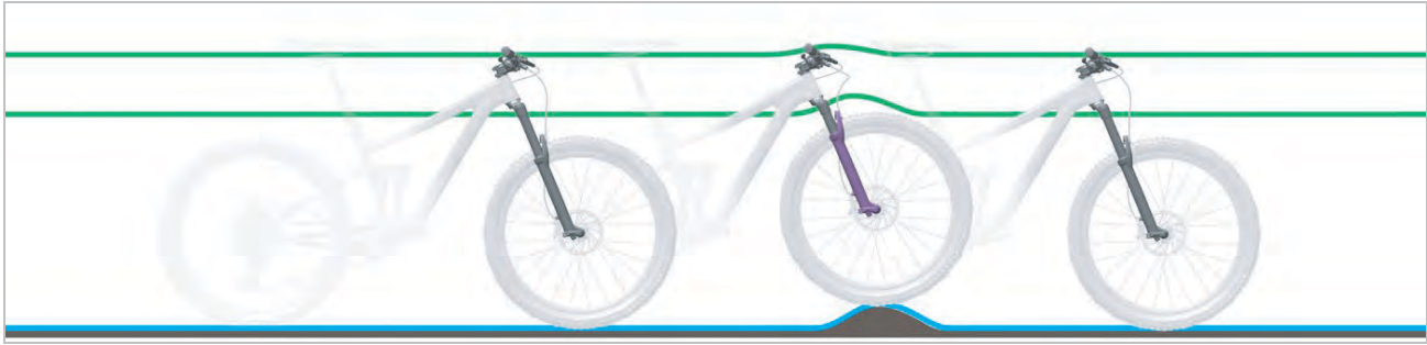
Abbildung 18: Optimales Fahrverhalten der Federgabel bei Unebenheiten
