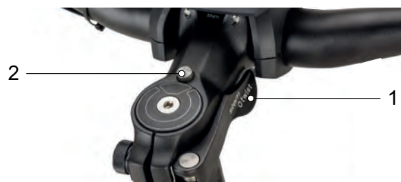
Abbildung 96: Vorbau, Ausführung II mit Spannhebel des Vorbau-Schnellspanners (1) und Entsperrknopf (2)
