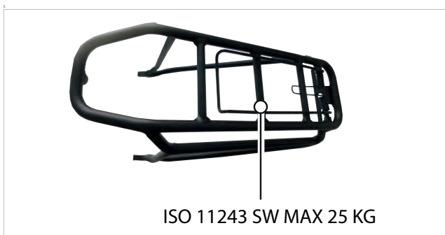
Abbildung 181: Auf dem Gepäckträger ist seine maximale Tragfähigkeit ausgewiesen
