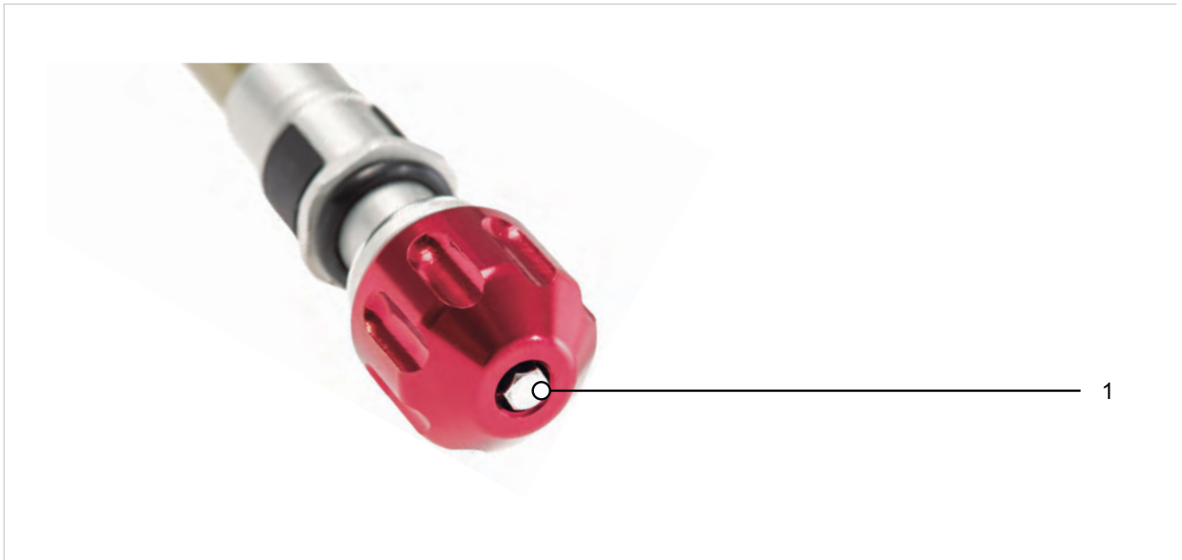
Abbildung 154: Beispiel SR SUNTOUR Zugstufen-Einsteller (Federgabel) (1)
