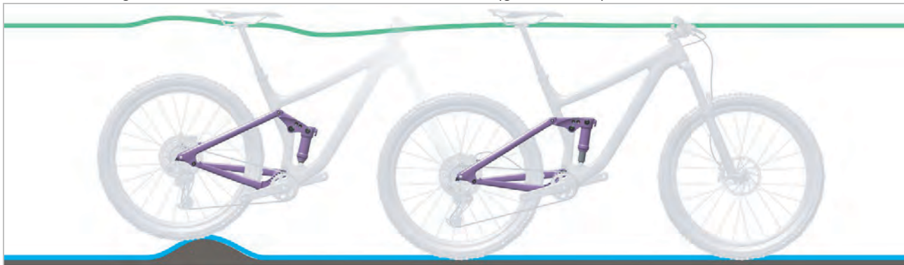
Abbildung 157: Optimales Fahrverhalten des Hinterbau-Dämpfers bei Unebenheiten
