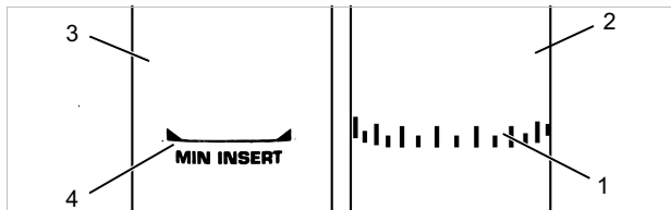
Abbildung 104: Detailsansicht Sattelstützen, Beispiele für die Markierung der Mindesteinstecktiefe
