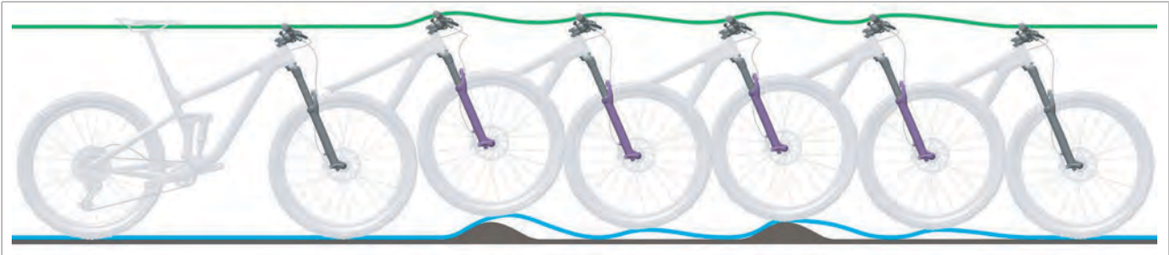
Abbildung 234: Zu schnelles Ausfedern der Federgabel
