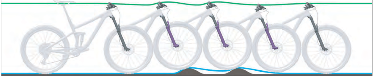
Abbildung 236: Zu langsames Ausfedern der Federgabel
