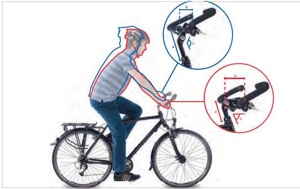
Abbildung 113: Citybike (blau) und Trekkingrad Position (rot) durch Winkeländerung
