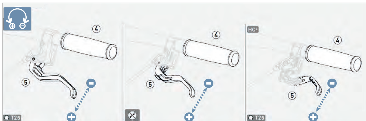
Abbildung 138: Griffweite Handbremse MAGURA Scheibenbremse einstellen
