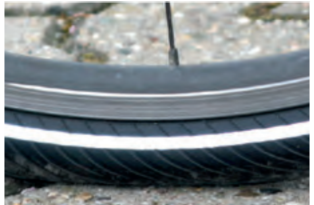
Abbildung 131: Korrekter Fülldruck. Der Reifen ist unter der Last des Körpergewichts kaum verformt
