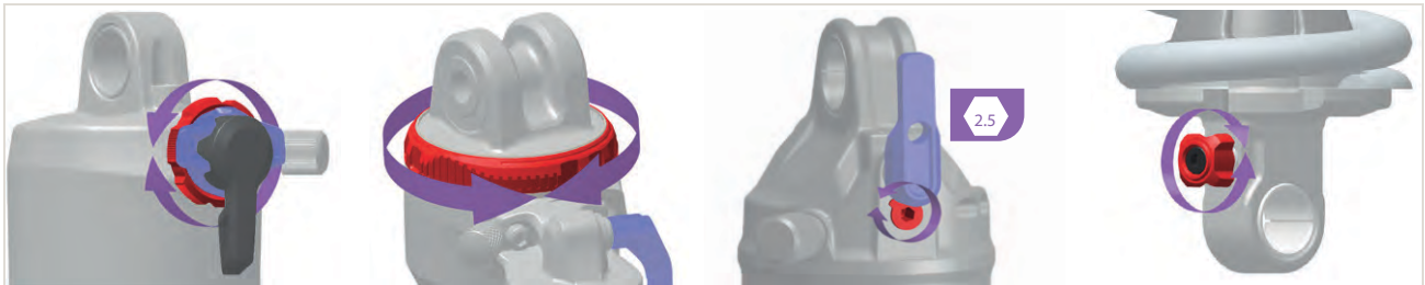
Abbildung 251: Lage und Form des Zugstufen-Einstellers (rot) ist Modellabhängig
