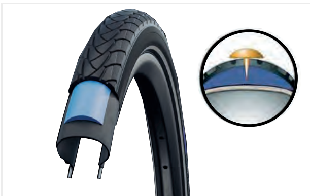
Abbildung 31: Wirkung Pannenschutz-Gürtel
