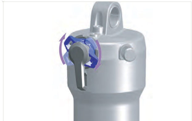
Abbildung 189: Druckstufen-Einsteller härter einstellen
