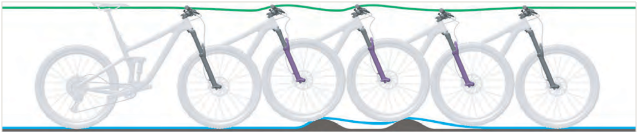
Abbildung 242: Zu langsames Ausfedern der Federgabel
