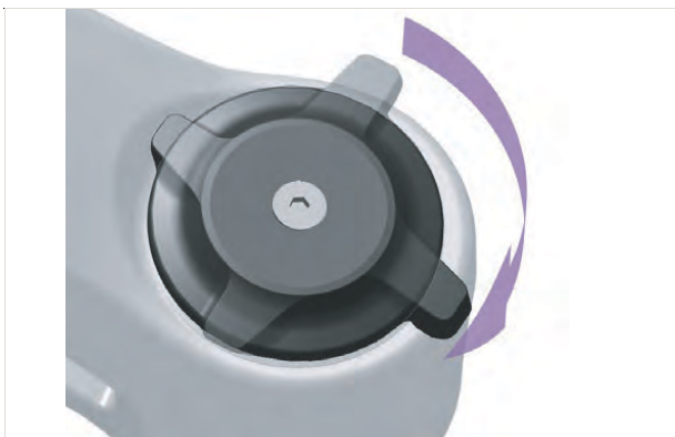
Abbildung 245: Druckstufen-Einsteller härter einstellen
