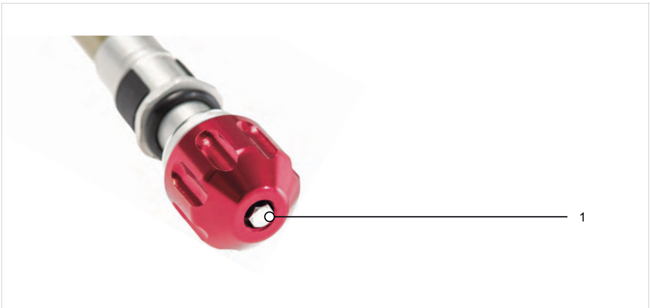
Abbildung 237: Beispiel SR SUNTOUR Zugstufen-Einsteller (Federgabel) (1)
