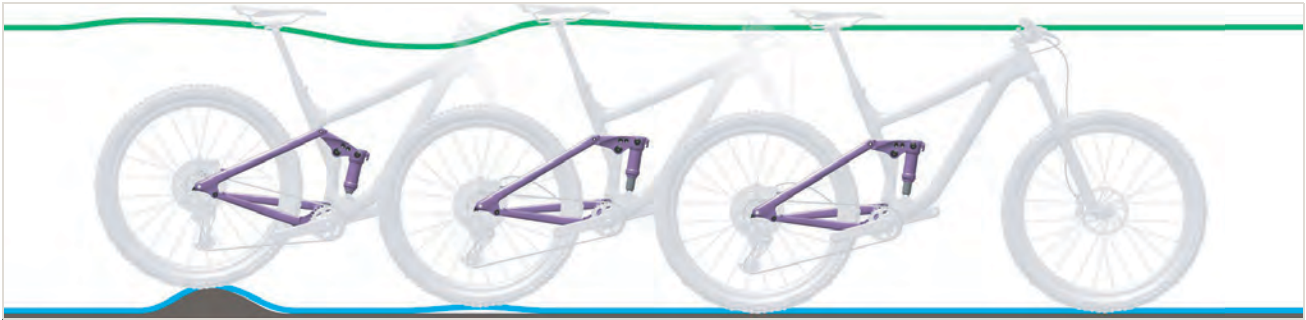
Abbildung 248: Zu schnelles Ausfedern des Hinterbau-Dämpfers
