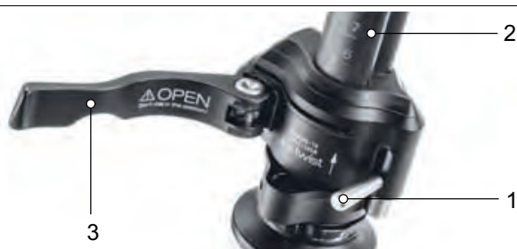
Abbildung 95: Geöffneter Spannhebel des Vorbau-Schnellspanners (3) am Vorbau (2), Ausführung I, mit Sicherungshebel am Vorbau (1)
