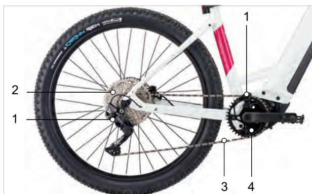
Abbildung 55: Schema Kettenantrieb mit Kettenschaltung
