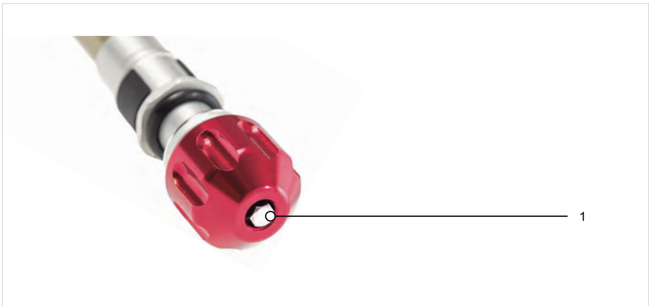
Abbildung 235: Beispiel SR SUNTOUR Zugstufen-Einsteller (Federgabel) (1)
