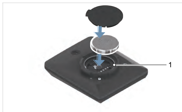
Abbildung 167: Batterie einlegen mit korrekt ausgerichtetem Dichtgummi (1)
