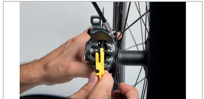
Abbildung 220: Bremsbelag im eingebauten Zustand mithilfe der Transportsicherung prüfen
